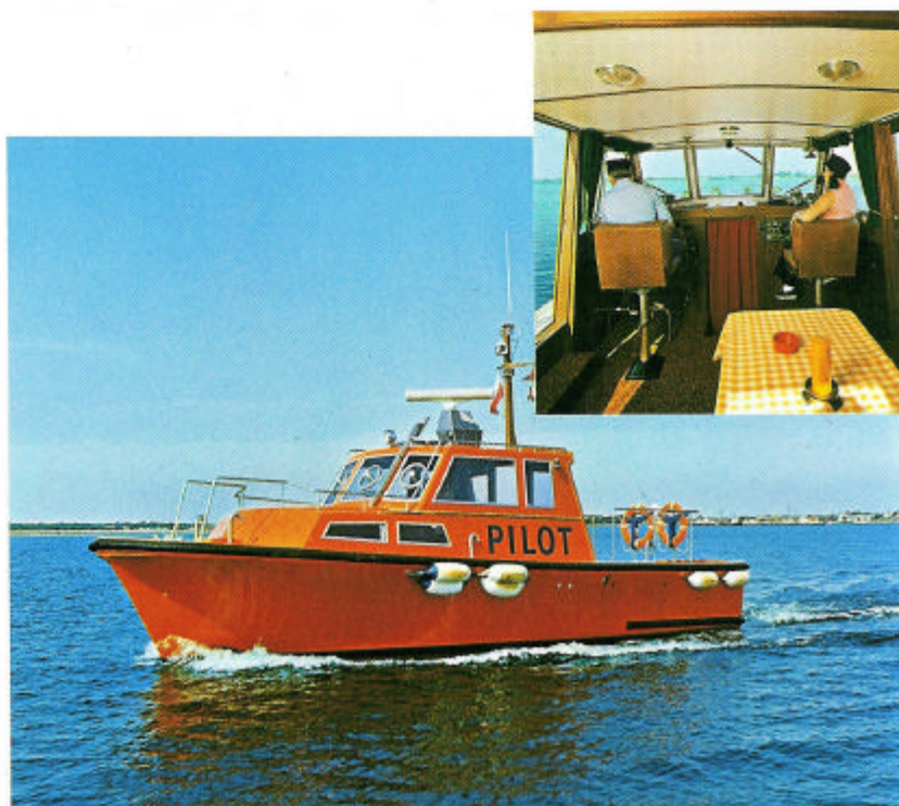
Das Bild rechts zeigt das zuletzt gelieferte 40' Lotsenboot an die Lotsenstation Hals Barre. 2 St. 185 PS Volvo Pentamotoren ergeben
